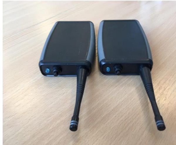
Figur 9: Radiosender og mottaker for kartlegging av dekning i anlegget.
