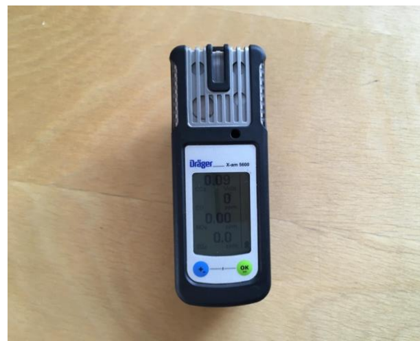
Figur 11: Dräger X-am 5600, for referansemåling av CO og SO_2 .
